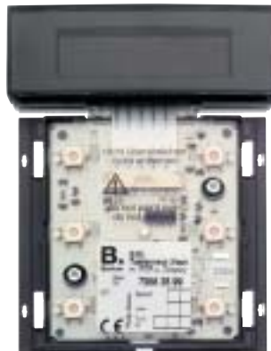
Die empfindliche Taster-Oberfläche wird erst zur Endmontage aufgeklipst. Vorher schützt eine Schutzfolie vor Verschmutzung.
