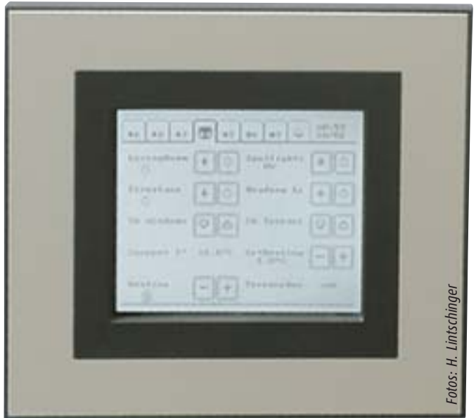
IPAS Touch Control: Erstes integriertes EIB-Touchdisplay, das ausschließlich über die ETS parametrierbar und programmiert wird.
